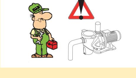
IT Con la pompa sotto il livello dell'acqua, prima dello smontaggio del coperchio filtro, chiudere le saracinesche in aspirazione e mandata.
